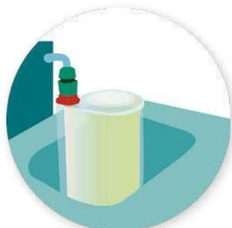
2. Abrir la entrada agua y sujetar el rodillo durante el proceso de lavado.
