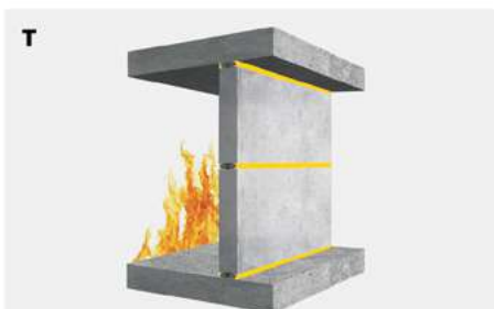
Doble sellado con Bostik FP 403 Fireseal Hybrid en combinación con el fondo de junta
