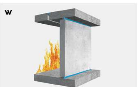
Sellado simple con Bostik FP 402 Fireseal Silicone en combinación con el fondo de junta
