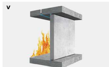
Sellado simple por el lado del fuego con Bostik FP 402 Fireseal Silicone en combinación con el fondo de junta
