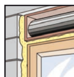
Relleno de huecos alrededor de cajas de persiana.
