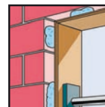
Sellado de juntas de ventana y alrededor del antepecho. Durante el montaje de marcos de puerta, se arristrarán.
