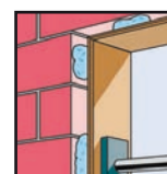
Sellado de juntas de ventana y alrededor del antepecho. Durante el montaje de marcos de puerta, se arristrarán.
