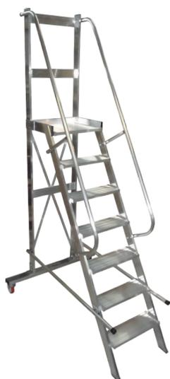
Escalera con plataforma fabricada en aluminio y de acuerdo a la normativa europea EN131-7. Diseño robusto y resistente, con barandillas a ambos lados y frontal, rodapié en todo el perímetro de la plataforma. Para una mayor comodidad y maniobrabilidad incorpora 2 rotantes fijos con freno y manetas de transporte. Con una inclinación de 60 grados. Peldaños y plataforma de perfil de aluminio estriado. Plataforma 500x400 mm. Peldaños de 160mm.
