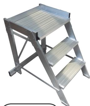
Taburete profesional tipo gradilla. Fabricado en aluminio de conformidad a la normativa europea EN14183. Diseño robusto y resistente, con plataforma y peldaños antideslizantes. Rodapie en todo el perímetro de la plataforma. Pies antideslizantes de caucho. Con una inclinación de 60 grados. Peldaños y plataforma de perfil de aluminio estriado. Plataforma 500x400 mm. Peldaños de 160mm.
