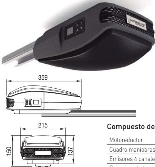
Alimentación de 220 V. 50 Hz y motoreductor de 24 Vdc. Emisores de frecuencia 433,92 MHz Rolling code. Final de carrera electrónico. Apertura y cierre suave. Pantalla digital exterior de fácil acceso. Cierre automático programable. Sistema antiplastamiento en caso de obstáculos. Luz de señalización de funcionamiento (máx. 3 min.). Funcionamiento estable y silencioso. Temperatura de trabajo de -10°C a + 40°C.
