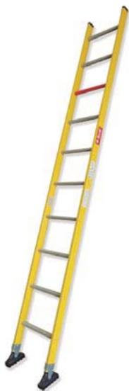
Escalera de un tramo con peldaños en forma "D", con huella de 30 mm. y antideslizante. Tacos basculantes de goma. Norma EN 61478 para trabajo en tensión. Las escaleras resisten los siguientes ensayos de rigidez dieléctrica sin producir contorneos, ni sufrir perforaciones o calentamientos significativos:
