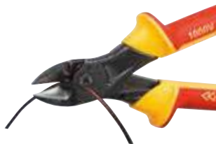
Material duro, como alambre de piano, cerca de la junta
