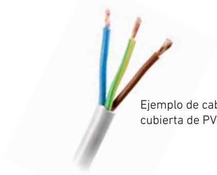
Ejemplo de cable de H05VV-F 3Gx1,5 mm (cable con aislamiento y cubierta de PVC, flexibles, 3 conductores de sección 1,5 mm<sup>2</sup>)
