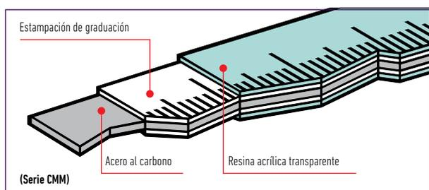
**Metálicas:** Cinta milimetrada en acero templado. Se utilizan para una medición muy profesional y exacta en largas distancias.
