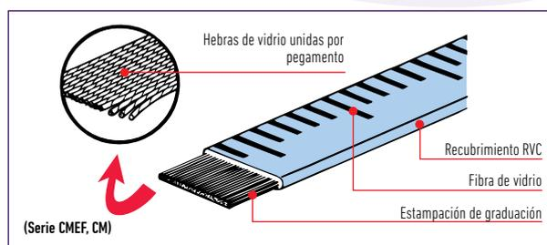
**Fibra de vidrio:** Cinta milimetrada en fibra de vidrio. No se dilatan ni se encogen ni se deforman. Son resistentes al agua, humedad y temperatura así como a la mayoría de productos químicos. Muy manejables por su poco peso. Se utilizan para una medición altamente profesional como ingeniería, topografía y en general para los amantes de la metrología de calidad.
