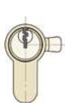
D LEVA A 90° A LA DERECHA 90° TO THE RIGHT PANNETON À 90° À DROITE
